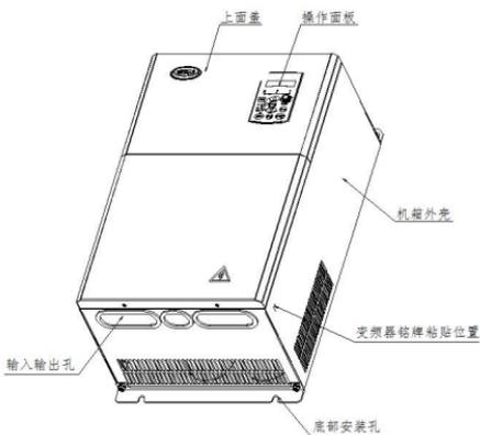
图2-5 SIV600变频器15kW~400kW外形图
